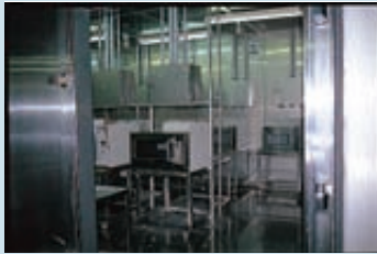
Kombinierter Belastungstest *(1) Temperatur von -40°C bis +85°C, relative Luftfeuchtigkeit 85%
