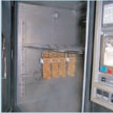
Leiterplatten-Bewertungstest *(1) Temperatur von -40°C bis +85°C, relative Luftfeuchtigkeit 85%
